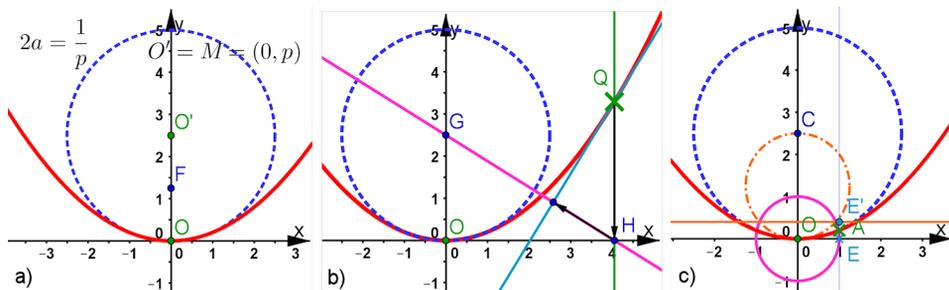
**Abb. 7.2** Aufgabe 7.1 b) Scheitelkrümmungskreis der Parabel a) Brennpunkt F, Ordinate verdoppeln, b) beliebiger Punkt Q auf der Parabel liefert mit dem Lot auf die Tangente den Mittelpunkt, c) Ordinate an der Stelle 1 verdoppeln, zugehörige Waagerechte am Einheitskreis spiegeln liefert den Mittelpunkt
