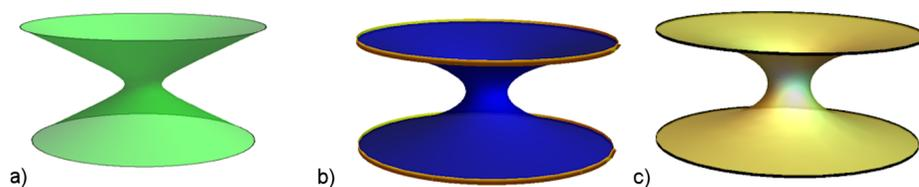
**Abb. 9.35** Rotationskörper, die x-Achse weist nach oben. **a) Hyperboloid, b) Paraboloid, c) Katenoid, die Minimalfläche**, sie wird von einer Seifenhaut zwischen den zwei Kreisen gebildet.
